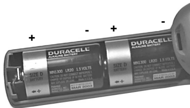
Figura 1. Pilas alcalinas debidamente instaladas
